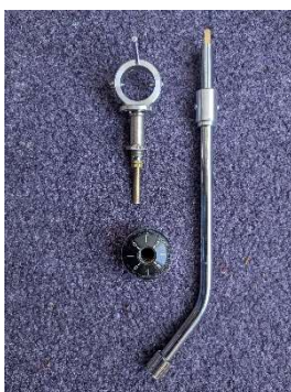
Lagerspitze bearbeitet und poliert
