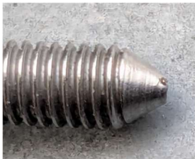
Lagerspitze bearbeitet und poliert
