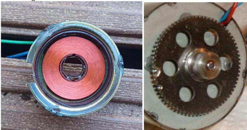
Rund um den Deckel (Bild links) ist ein ringförmiger Dauermagnet, dreht sich nun der Rotor des Motors entsteht an der Tachoscheibe (Bild rechts) wechselndes Magnetfeld, welches nun mittels der Spule im Deckel einen elektrischen Strom induziert. Vergleichbar mit einem Dynamo von einem Fahrrad.
