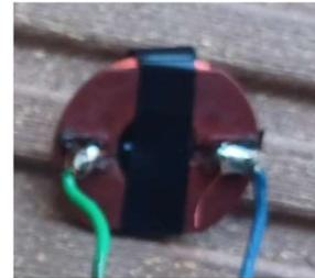
Der Rest ist dann relativ einfach. Die Drähtchen durch die Bohrung führen und die Spule auf dem Träger mit dünnen Doppelseitigen Klebeband fixieren. Notfalls geht auch Sekundenkleber, aber dann ist jeder weitere Reparaturversuch für alle Zeit unmöglich.
