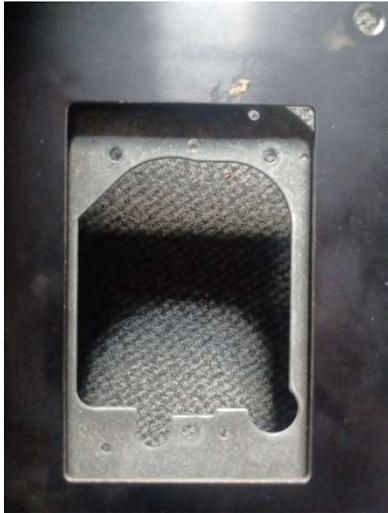
Besonders schön ist, dass sogar Bohrungen und eine Liftaussparung bei der Montageöffnung schon vorhanden sind. Dem Thorensbaukasten sei es gedankt.
