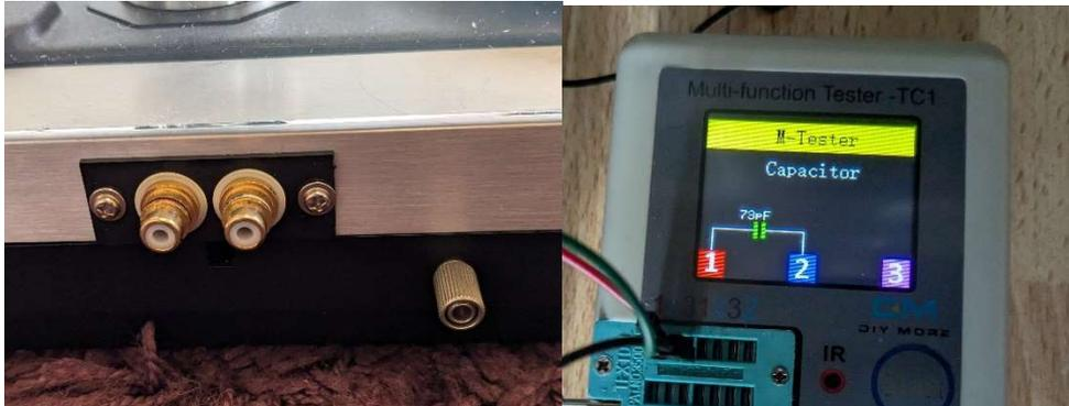
Die Messung ergab dann für den Tonarm ohne System bis zur Buchse 73 pF, damit ist für die Verkabelung reichlich Luft zum spielen. Stichwort: Kapazitätsanpassung.
