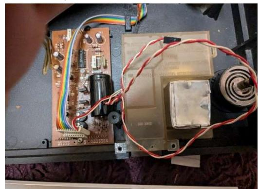
Da ich das Netzteil schon einmal offen hatte, wurden auch gleich die Zuleitungen für die Glimmlampe abgelötet und ein altes Buchsenkabel aus einem SchlachtPC an die Niederspannungsleitungen (rot / weiß) angelötet, da ich das Stroboskop auf LED umstellen wollte.
