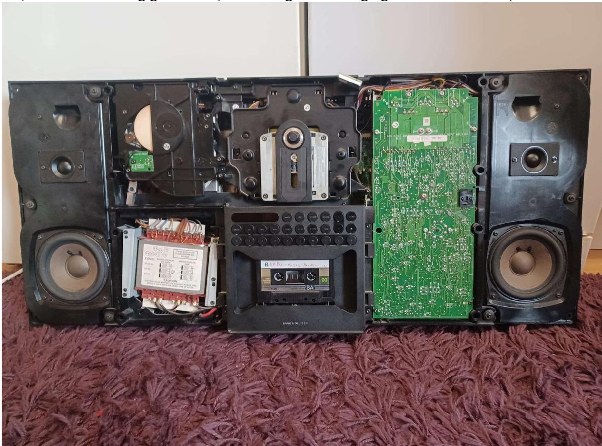
Erster Eindruck: Gar nicht so dumm aufgebaut (die Abdeckung für das CD-Laufwerk nebst Klappe ist hier schon entfernt). Es ist zwar eine Kompaktanlage, aber die Einzelkomponenten sind wirklich weitestgehend separat verbaut.
